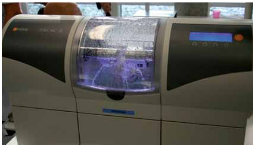
Cerec_MC_XL Schleifeinheit (Cerec 3D): Schleifprozess in vollem Gange (Fa. Sirona); deutlich schneller als Cerec 2
